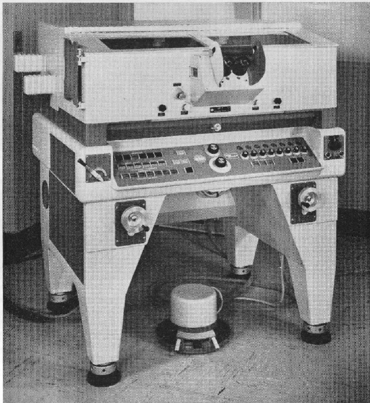
Fig. 9a. Meß- und Beobachtungsgerät des Analytischen Plotters AP/C von O.M.I.
